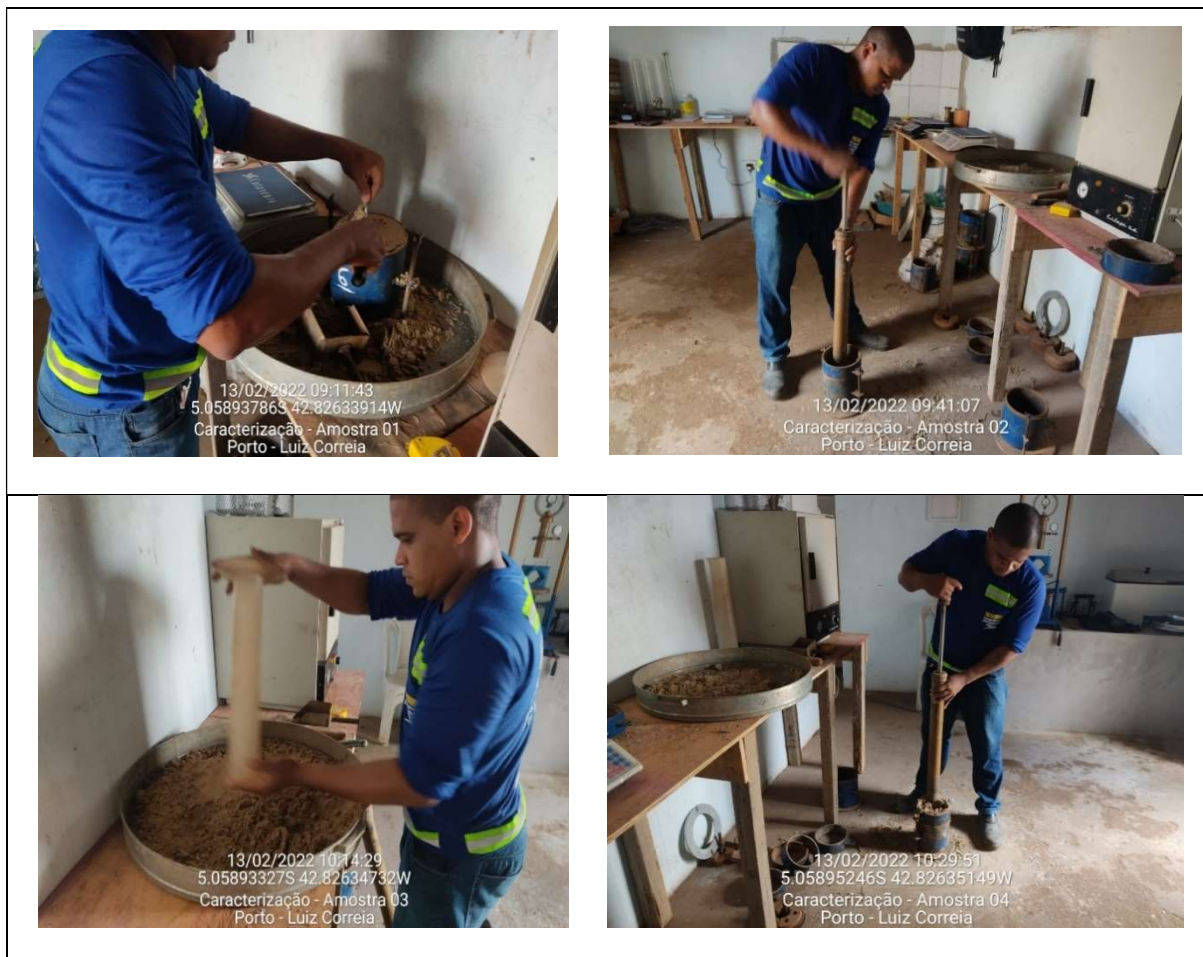
Foto 13 - Ensaio de compactação Fonte: LG3 Engenharia, 2022
