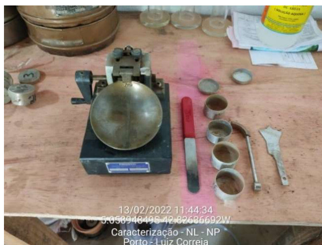
Foto 12 - Aparelho para ensaio de liquidez e plasticidade. Fonte: LG3 Engenharia, 2022
