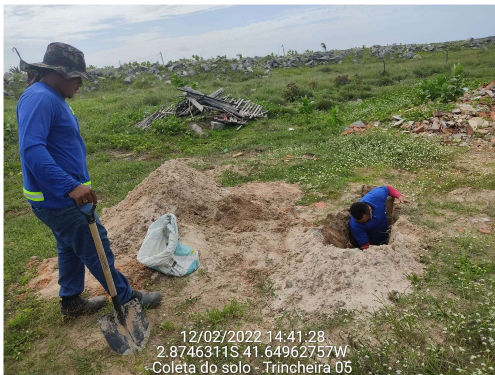
Foto 6 - Coleta de solo na Trincheira 05 no local do Empreendimento
