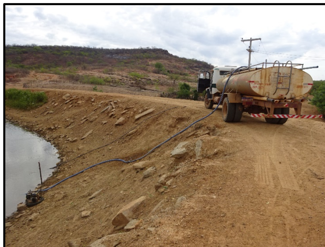
FOTO 6.4.9.2 – Captação de água de açude, por meio de caminhão-pipa, no Povoado Baixão do Moisés, para abastecimento de cisternas.
