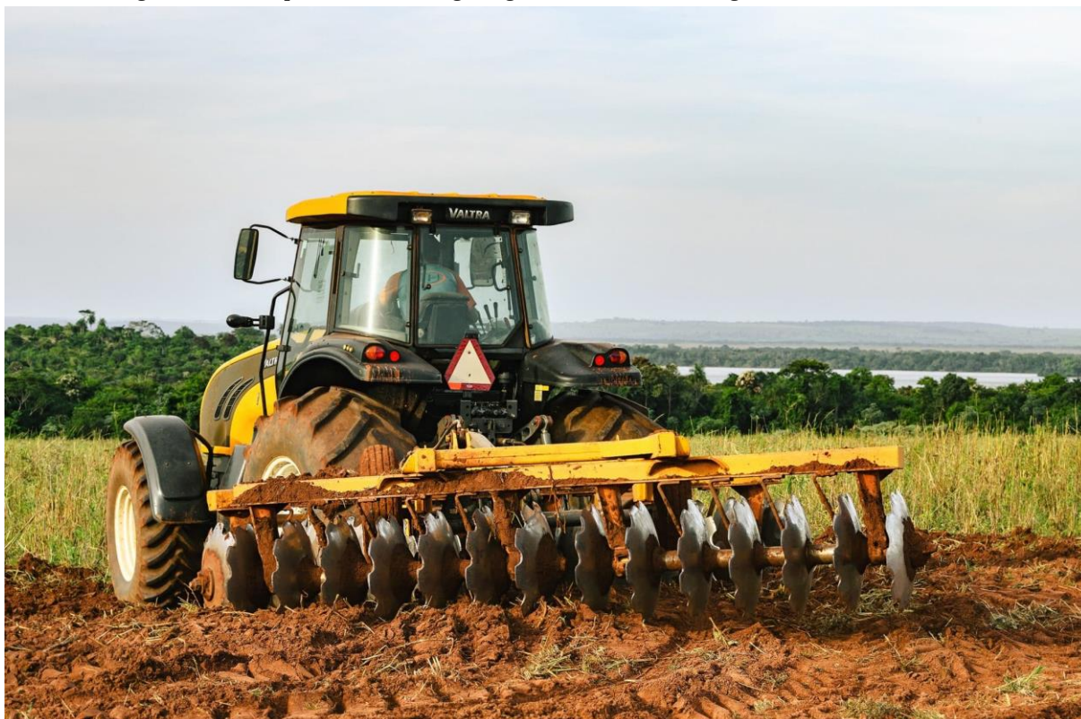
Figura 15 - Exemplo da técnica de gradagem do solo utilizando grade niveladora de discos.
